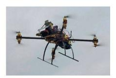
Abb. 1: Oktokopter mit Ausrüstung (Durchmesser: 80 cm).
