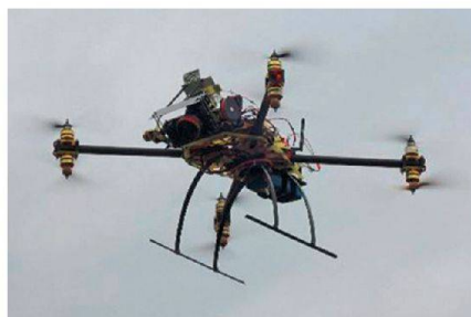
Abb. 1: Oktokopter mit Ausrüstung (Durchmesser: 80 cm).
