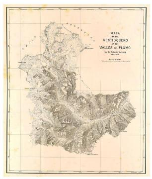
Abb. 5: Mapa de los Ventisqueros en los Valles del Plomo, Zusammensetzung der drei Teilblätter Parte d. Norte, Parte meridional, Parte oriental im Massstab 1:50 000, Äquidistanz 50 m. Dreifarbiger Steindruck, Format 62 x 80 cm (innere Randlinie). Probedruck der Schweizerischen Landestopographie; Bearbeitung jedoch durch Kartographia Winterthur (?). (Privatbesitz).
