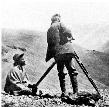
Abb. 2: Robert Helbling am 24. Februar 1909 bei ersten Vermessungsarbeiten auf dem Cerro Rotondo. Der chilenische Maultiertreiber «el Negro» hilft bei starkem Wind den Phototheodoliten zu stabilisieren (aus: Larden 1974).
