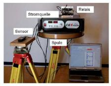
Abb. 2: Experimentalsystem mit dreiachsigem Magnetfeldsensor, einer Spule ( $r_0 = 0.25$  m; N = 140) inkl. Relais, Labornetzteil sowie Messrechner.
