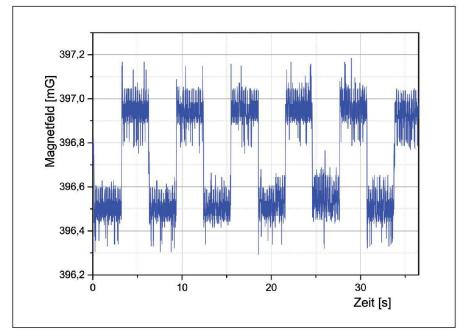
Abb. 3: Aufgezeichnetes Spulensignal (I = 12 A) bei 12 m Entfernung.
