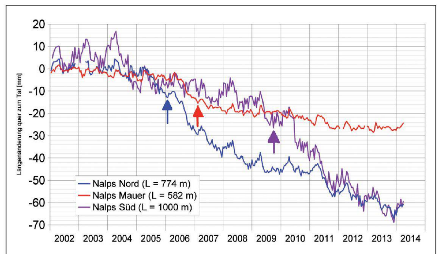
Abb. 2: Talflankenbewegungen in Querrichtung auf dem jeweils obersten Messniveau. «L» stellt die Horizontalabstände zwischen den beiden Punkten dar. Die Pfeile zeigen den Zeitpunkt der Unterquerung des jeweiligen Messquerschnitts.
