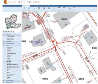
EW-Werkplan: lagegenaue Trasse-Führung inkl. Rohrprofil und Kabelbelegung, Verteilkabinen und Trafostationen, Schächte, Hausanschlüsse etc.
