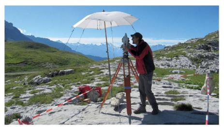
Abb. 4: Einmessung der Rückversicherungen nahe dem Sanetschpass.
