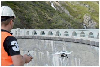
Der Aibotix X6, ein leichter, unbemannter Multikopter, ergänzt auf ideale Weise die Luftbildlösungen von Leica Geosystems. Das System bietet deutliche Vorteile bei der sicheren 3D-Datenerfassung und der Inspektion von unzugänglichen Infrastrukturen wie Stromleitungen, Brücken, Staudämmen und Kraftwerken. Sehen Sie hier ein Anwendungsbeispiel: www.youtube.com/watch?v=wkbWEMq\_cOg
