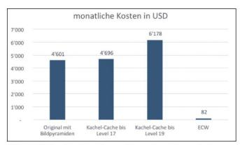
Abb. 2: S3 Cloud Speicherkosten (Daten berechnet mit Amazon Simple monthly calculator im Dezember 2013 mit jeweils identischen Parametersettings).
