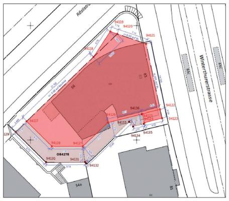
Abb. 2: Beispiel für eine Baumassberechnung.
