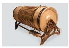
Abb. 1–4: Ende 2013 wurden am Departement Informatik der ETH Zürich und im Konzernarchiv der UBS Basel gleich zwei sehr seltene, über 100-jährige Loga-Rechenwalzen mit einer Skalenlänge von 24 m gefunden. In der Mitte der seitlich verschiebbare und drehbare Schieber. Nach unserem Wissen handelt es sich dabei um die weltweit grössten Rechenwalzen. (© Hansjörg Leimer/Daniel Nasshan, UBS AG, Basel und Zürich).
