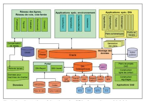
Fig. 1: Représentation schématique simplifiée des systèmes périphériques.
