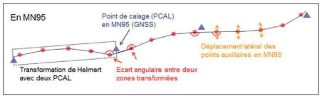
Fig. 2: Représentation schématique de la transformation des voies avec Swiss-RailTra95.
