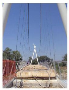
Abb. 6: Als Gewichte kamen mit Wasser gefüllte Behälter zum Einsatz.
