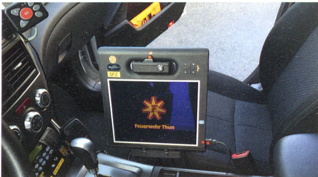
Motion F5te Tablet PC inkl. Mobile Dock im Einsatzleiterfahrzeug. Tablette Motion F5te incluant la station Mobile Dock dans le véhicule du chef d'intervention.
