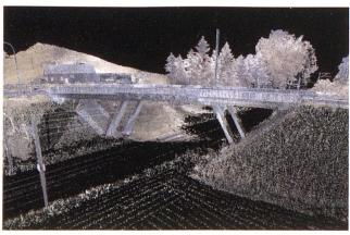
Abb. 2: Punktwolke Eisenbahnbrücke.
