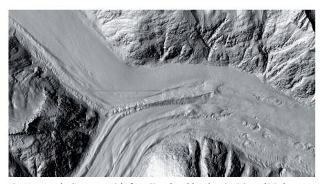
Fig. 8: Exemple de passage à la frontière d'un bloc de mise à jour dû à des manteaux neigeux différents lors des années de vol 2010 et 2011.
