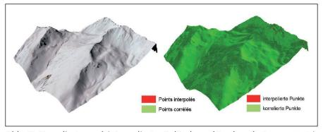
Abb. 3: Korrelierte und interpolierte Geländepunkte des photogrammetrischen Oberflächenmodells vom Testgebiet Wannengrat, Winter 2012. Fig. 3: Points du terrain corrélés et interpolés du modèle de surface photogrammétrique, zone de test de Wannengrat (hiver 2012).
