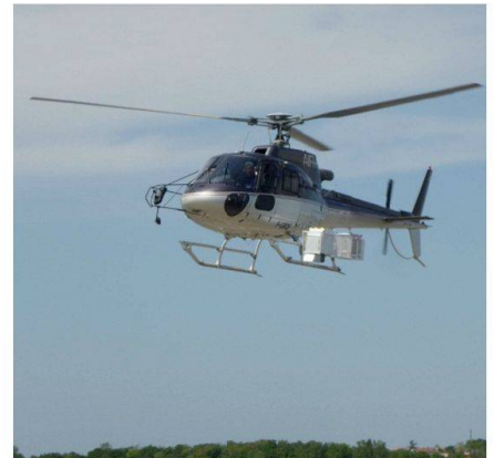
Abb. 6: Helikopter mit Laser und Mittelformatkamera zur Dokumentation von Freileitungen.
