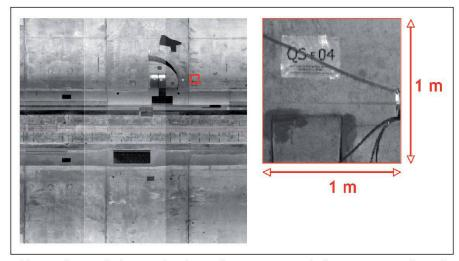
Abb. 3: Abgewickeltes Orthophoto der GBT-Innenschale zum Zeitpunkt «Abschluss Rohbau». Die Auflösung am Objekt beträgt 5 mm.
