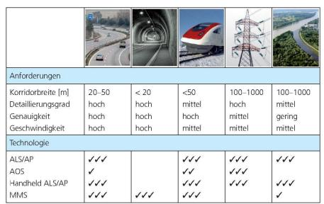
Tab. 2: Erfassungsmethoden für Korridorprojekte und deren Eignung. (ALS = Airborne Laserscanning; AP = Airborne Photogrammetry; AOS = Aerial Oblique Systeme; MMS = Mobile Mapping System).
