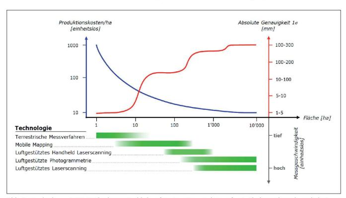
Abb. 9: Vergleich von MMS-Methoden im Hinblick auf Kosten, Genauigkeit, erfasste Fläche und Geschwindigkeit.
