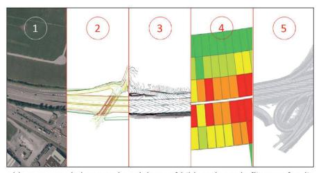
Abb. 5: Datenerhebung und Produkte: Luftbild- und Laserbefliegung für die gesamte Korridorbreite zur Produktion von Orthophotos (1) und Geländemodellen. Mobile Mapping-Befahrung aller Fahrspuren und Ableiten von Vektorplänen (2). Darstellung des Geländemodells als Höhenlinien (3) und als trianguliertes Netz (5). Ebenheitsanalysen (4) gemäss Richtlinien VSS Schweizerischer Verband der Strassen- und Verkehrsfachleute.
