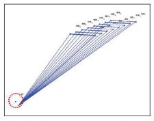
Abb. 3: Prinzip Koordinaten-Update mittels Multi-Image-Matching (Referenz-Passpunktkoordinate in gestricheltem Kreis).
