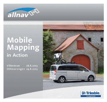
Das mobile Scan- und Videosystem Trimble MX8 ist eine innovative Lösung für die schnelle und präzise Vermessung grosser und langgezogener Objekte. Die Lösung vereint 3D-Scanner mit digitalen Videos und hochpräziser Geo-Referenzierung mittels GNSS und Inertialsystem.
