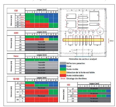
Fig. 8: Scans des fentes verticales à largeurs variables.
