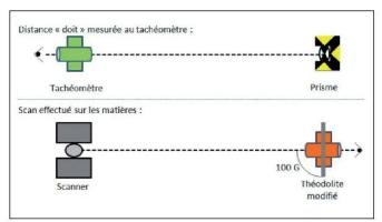
Fig. 1: Schéma de mesure des distances.
