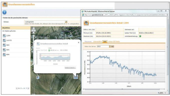
Abb. 2: Grundwasserstand einer Messstelle in einem gewählten Zeitraum.
