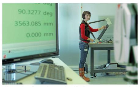
Abb. 1: Tracker Pilot DRO (Data Read Out) bei der Messung mit 1.5" RRR (Red-Ring Reflector) und Leica Absolute Tracker AT401 (Foto: Hexagon Metrology).
