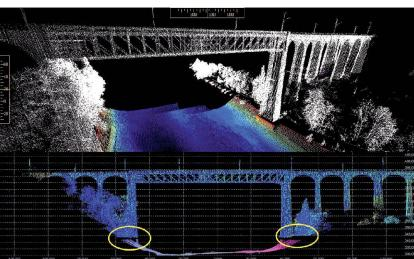
Abb. 3: Darstellung der aufgenommenen Laserscanning-Daten vom Rhein in Basel und visuelle Genauigkeitsanalyse von drei gescannten Profilen mit Abweichungen von 2–3 cm (links) sowie Fächerecholot-Daten und Laserscanningdaten von der Eisenbahnbrücke über den Rhein bei Eglisau ZH mit einer Datenlücke von 50 cm durch den verwendeten Öffnungswinkel von 90° (besser 105°) beim Fächerecholot (rechts).
