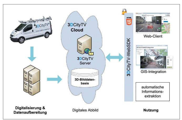
Abb. 3: Workflow und Architektur eines 3DCityTV 3D-Geobilddienstes.
