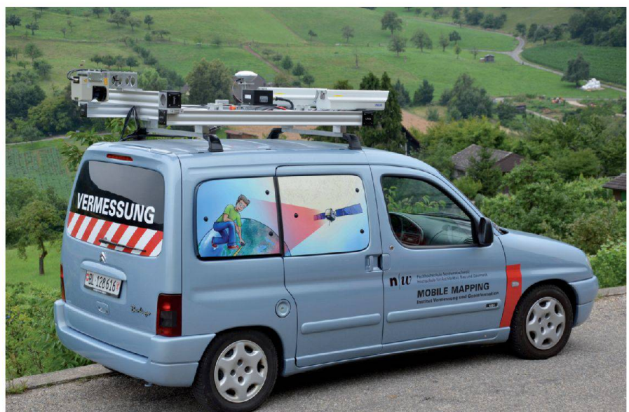
Abb. 1: Stereovision Mobile Mapping System des IVGI in einer Versuchskonfiguration mit einem optionalen Laserscanner.
