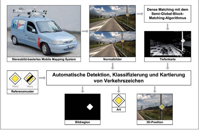
Abb. 2: Automatisierte Verkehrszeichenkartierung aus mobil erfassten Stereobilddaten (Cavegn, 2010).
