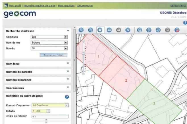
rents formats de fichiers, comme les formats PDF et DXF ainsi que les géodatabases pour l'export de données. Pour l'extraction de plans, l'utilisateur peut choisir le format d'impression, l'échelle et au besoin un angle de rotation.
