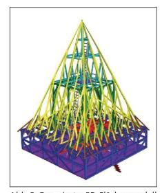
Abb. 3: Generiertes 3D-Flächenmodell des Turmdachstuhls.
