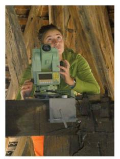
Abb. 4: Bei der Arbeit mit der Balkenklemme.
