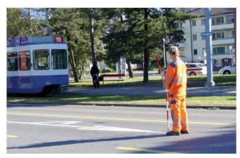
Abb. 4: Tachymetrische Passpunktbestimmung einer Strassenmarkierung (Quelle: GeoZ).
