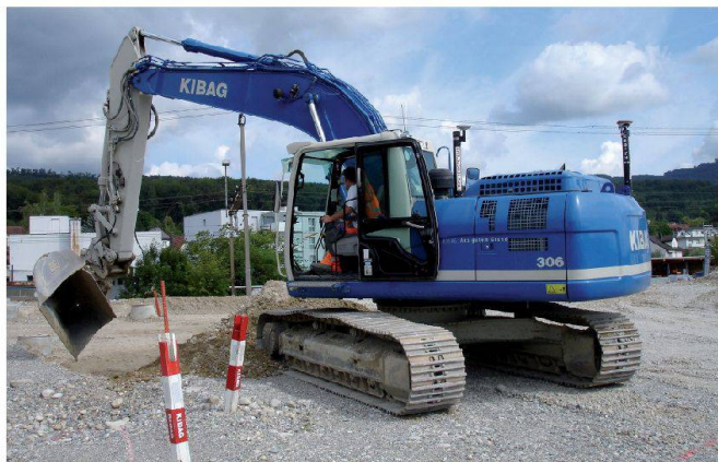
Abb. 3: 3D-Baggersteuerung mit GPS/GNSS. Fig. 3: Pilotage 3D de la pelle mécanique avec GPS/GNSS. Fig. 3: Comando escavatore 3D con GPS/GNSS.
