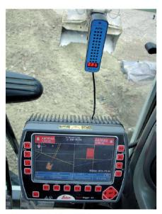
Abb. 2: Bildschirm 3D-Baggersteuerung. Fig. 2: Écran du pilotage 3D d'une pelle mécanique.
