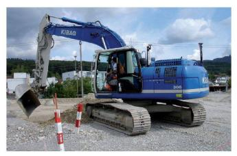
Abb. 3: 3D-Baggersteuerung mit GPS/GNSS. Fig. 3: Pilotage 3D de la pelle mécanique avec GPS/GNSS.
