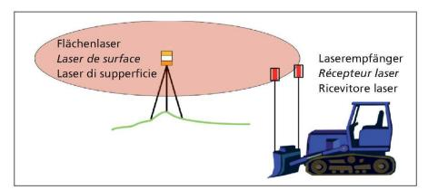
Abb. 1: Beispiel 2D-Steuerung Dozer mit Rotationslaser. Fig. 1: Ex.: Pilotage 2D d'un bulldozer avec laser rotatif.
