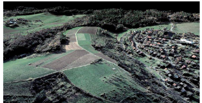
Abb. 10: In ImageStation 2013 generierte Punktwolke mit RGB-Kodierung.
