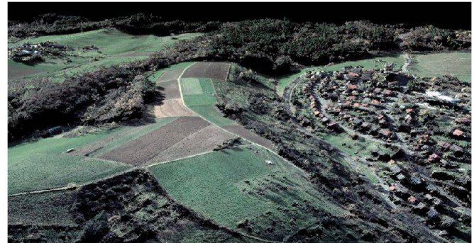
Abb. 10: In ImageStation 2013 generierte Punktwolke mit RGB-Kodierung.
