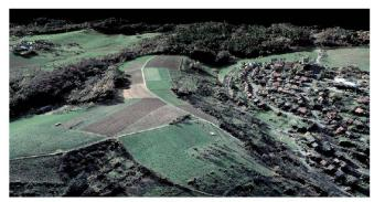
Abb. 10: In ImageStation 2013 generierte Punktwolke mit RGB-Kodierung.
