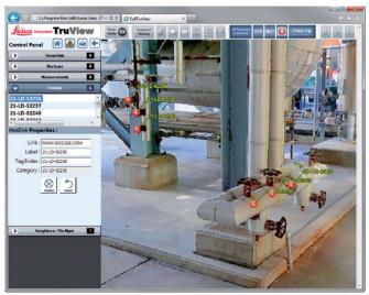
Dieses Bild zeigt die Bedienoberfläche von Leica TruView. Im Fenster rechts ist eine photorealistische Panoramaansicht einer Punktwolke mit Informationen dargestellt. In der Ansicht sind auch mehrere «Hotlinks» bei den Ventilen platziert. Anwender können auf diese Hotlinks klicken, um Objektdaten und andere Anlageninformationen zu erhalten.
