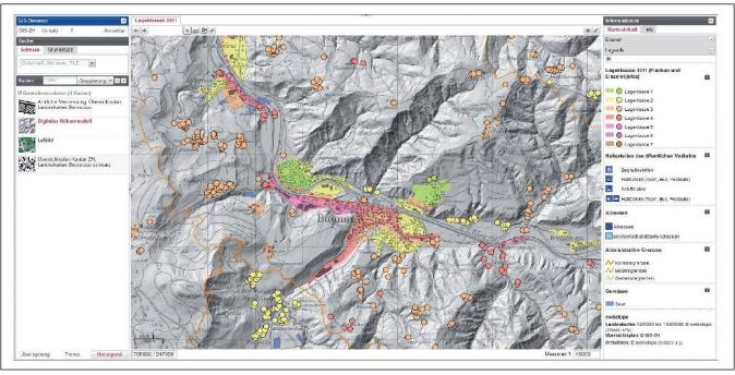
Abb. 1: Der neue GIS-Browser mit der Aufteilung in drei Panels ist übersichtlicher und komfortabler in der Handhabung. Kartenauswahl, Suchfenster und Legende der aktuellen Karte sind auf einen Blick sichtbar.
