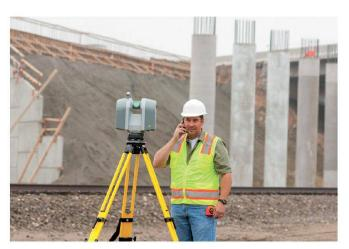
bis zu 120 m. So können mit dem Trimble TX8 präzise 3D-Punkt-wolken mit hoher Dichte schnell und einfach erzeugen werden. Der Trimble TX8 zeichnet sich durch unerreichte Flexibilität aus, denn die Reichweite der Messungen lässt sich bis auf 340 m vergrössern. Das verringert die Anzahl der beim Scannen vor Ort erforderlichen Standpunkte und die Einsatzmöglichkeiten des Trimble TX8 werden dadurch beträchtlich erweitert.
