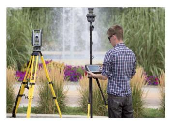
aufweisen (z.B. Industrieanlagen in der Öl- und Gaswirtschaft), sodass sich auch grössere Datenmengen mit geringem Zeitaufwand bewältigen lassen. Die auf dem robusten Trimble Tablet PC installierte Trimble Access Feldsoftware bietet in einfachen und intuitiven Schritten die Möglichkeit, Bilder aufzunehmen und zu überprüfen sowie Messungen zu speichern.
