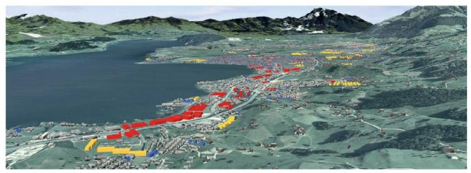
Abb. 1: Kubaturen einer möglichen Bebauung mit ortsüblichen Höhen; die Farben stellen die unterschiedlichen Potenzialkategorien dar: Innenentwicklung (in Rot); Baulücken (in Blau); Aussenreserven (in Gelb) (Datengrundlagen: SWISSIMAGE © swisstopo; DV 012725).
