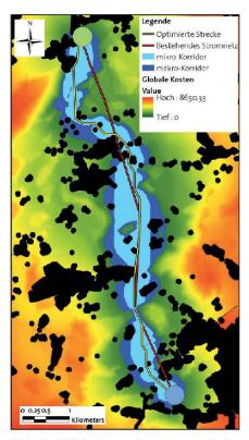
Abb. 3: GIS-basierte Streckenoptimierung zur Stromnetzeinbindung (Masterarbeit P. Moll).
