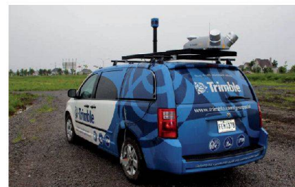
Trimble MX2 mit Panoramakamera und mit Odometer.
