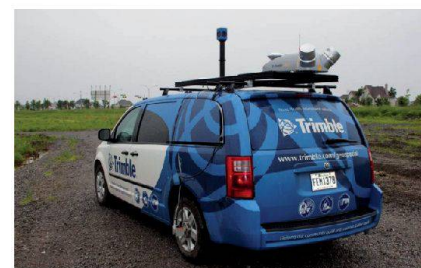
Trimble MX2 mit Panoramakamera und mit Odometer.
