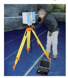
Abb. 3: Laserscanning im Gletscher-Palast, Zermatt, im Rahmen einer Lehrveranstaltung (Foto: P. Theiler).
