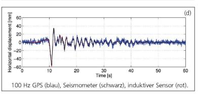
Abb. 1: (a) Forschungsaspekte: (a) Mikrotriangulation am CERN, (b) GPS-Verschiebungen und Geschwindigkeiten des Dirru-Blockgletschers, (c) Cube-Satellit (Swisscube; Quelle: Swiss Space Center), (d) GNSS-Seismologie: Rütteltischsimulationen des Aquila-Erdbebens (50% Amplitude).
