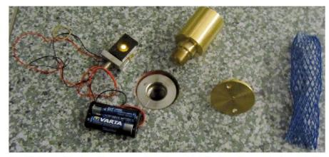
Fig. 11: Ensemble des pièces permettant la matérialisation des points de contrôle. Abb. 11: Gesamte Teile für die Materialisierung der Kontrollpunkte.
