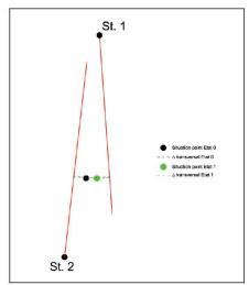
Fig. 4: Lignes gauches, principe du contrôle des mouvements.
