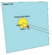
Fig. 8: Détermination de l'appoint de lecture entre l'axe numérique (Principal Point de l'image) et le point à observer.
