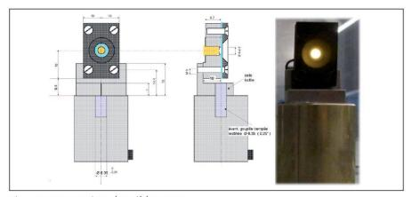
Fig. 10: Conception des cibles-LEDs. *Abb. 10: Konzeption der LED-Ziele.* Fig. 10: L'allestimento delle mire LED
