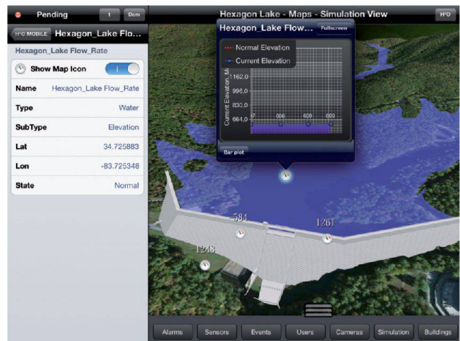
Mobile Anlagenüberwachung mit Intergraphs H 2 O Mobile , hier mit aufgeschaltetem Pegelmonitoring.
