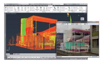
Die Multifunktionsleiste der Leica MultiWorx für AutoCAD Plugin-Software erlaubt die farbige, intensitätskartierte Darstellung der Punktwolken im Hauptfenster von AutoCAD. Ausserdem kann das exklusive MultiWorx TruSpace Fenster angezeigt werden, das die gleiche Ansicht der Punktwolke in fotorealistischen Echtfarben und das Panoramabild der Leica Nova MS50 als Hintergrund, einschliesslich Himmel usw., als wertvollen Kontext für den Benutzer anzeigt.
