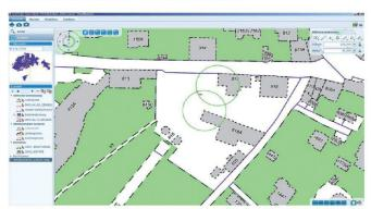
Benutzeroberfläche von GeoMedia Smart Client mit Punkt-Fangfunktionen (Snapping) und Konstruktionshilfen.
