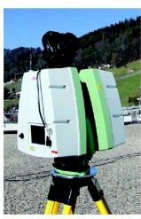
Die neue externe Kamera-Option für die Leica ScanStation C10 erlaubt das Überlagern hochauflösender Bilder auf die erfasste Punktwolkenoberfläche.
