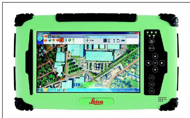
Der Leica CS25 LRBT Tablet-PC und Feld-Controller bietet die Möglichkeit, drahtlos mit einem Gerät, wie z.B. einer Leica Geosystems Totalstation, über eine Distanz von bis 350 m zu kommunizieren.
