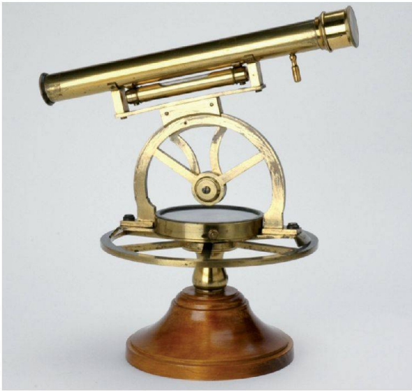
Abb. 3: Theodolit um 1820 der Firma W.&S. Jones, London.
