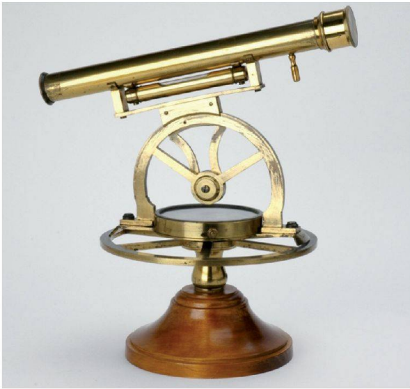
Abb. 3: Theodolit um 1820 der Firma W.&S. Jones, London.
