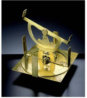
Abb. 2: Früher Theodolit ohne Fernrohr, um 1700.
