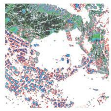
Abb. 2: Differenz aus digitalem Oberflächen- und Terrainmodell.
