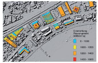
Fig. 4 et 5: Rayonnement global annuel en kWh/m²/an pour une zone située à Morges (gauche). Surfaces de toiture reconnues et leur rayonnement global moyen annuel en kWh/m²/an pour une zone située à Morges. Pour le calcul du rayonnement sur les toits plats, on a supposé la mise en place d'une installation solaire avec des supports inclinés, une orientation au sud et une pente de 30 degrés.
