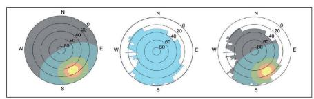
Fig. 3: Approche de l'analyse d'ombrage pour le rayonnement diffus: distribution du rayonnement (à gauche), ligne d'horizon (au milieu) et partie visible de la distribution du rayonnement (à droite).
