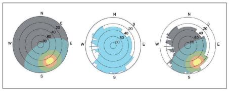
Abb. 3: Vorgehen bei der Verschattungsanalyse für die diffuse Strahlung: Strahlungsverteilung (links), Horizont (Mitte) und sichtbarer Teil der Strahlungsverteilung (rechts).
