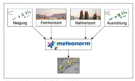
Abb. 1: Berechnungsmethodik für ein Solarkataster.
