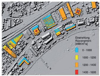
Abb. 4 und 5: Jährliche Globalstrahlung in kWh/m²/Jahr für einen Ausschnitt in Morges (links). Erkannte Dachflächen und ihre mittlere jährliche Globalstrahlung in kWh/m²/Jahr für einen Ausschnitt in Morges. Für Flachdächer wurde bei der Strahlungsberechnung von einer aufgeständerten und nach Süden ausgerichteten Solaranlage mit einer Neigung von 30 Grad ausgegangen.
