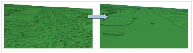
Fig. 5: Différence entre le nuage de points Lidar triangulé (à gauche) et le MNR avec une perspective au niveau du sol (à droite).
