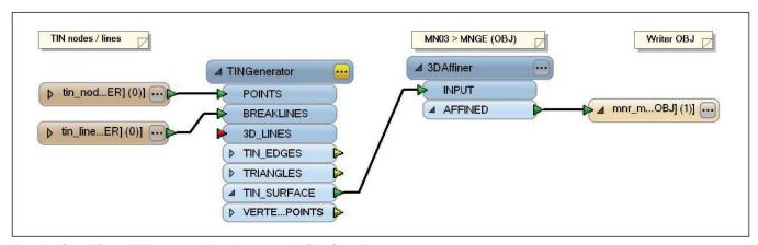
Fig. 6: Algorithme FME pour créer et convertir les données.
