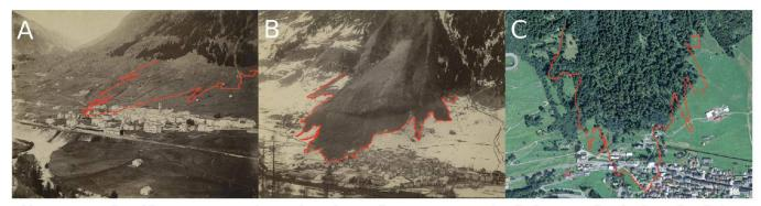
Abb. 5: Grenze der Ablagerungszone einer Erdrutschung, die am 28.12.1898 in Airolo stattgefunden hat: a) Auf einem älteren Bild von Airolo (© Staatsarchiv vom Kanton Tessin). b) Auf einem Bild von 1898 unmittelbar nach der Rutschung (© Staatsarchiv vom Kanton Tessin). c) Auf einer aktuellen Orthophoto (© Swisstopo). Schön sichtbar, wie auf Grund von der Rutschung Grossteile der Ablagerungsfläche nicht mehr kultiviert worden und somit zu Wald gewachsen sind.
