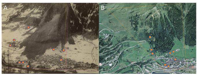
Abb. 2: Kalibrierung der Kamera: a) Benutzte Passpunkte auf dem Bild (Pixelkoordinaten) und Korrektur (Kalibrierung) der Kamera-Position zur Zeit der Aufnahme gegenüber der Senkrechte. b) Benutzte Passpunkte auf der Orthophoto (reelle Koordinaten) und gelb umrahmt, der auf dem Bild sichtbare Geländeausschnitt.
