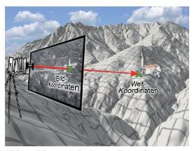
Abb. 1: Schematische Darstellung der Systemelemente der Monophotogrammmetrie: die Kamera, das Schrägbild einer Landschaft sowie die entsprechenden Geländemodelle und reelle Welt.
