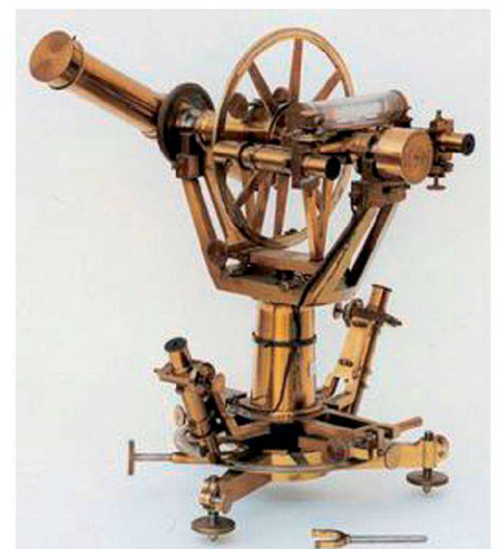
Fig. 4: Teodolite, detto Piccolo Universale di Repsold, Istituto Geografico Militare, Firenze.
