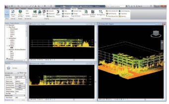
Aus den Laserscandaten lassen sich direkt in «Leica CloudWorx für Revit» Gebäudemodelle erstellen.
