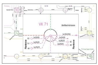
Abb. 2: Netzschema eingefärbt nach Stationskreisen.
