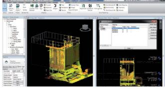
BIM-Anwender können mit «Leica CloudWorx für Revit» die Punktwolken aus Laserscandaten direkt in AutoCAD®Revit® bearbeiten sowie Schnitte und Limitboxen verwalten.
