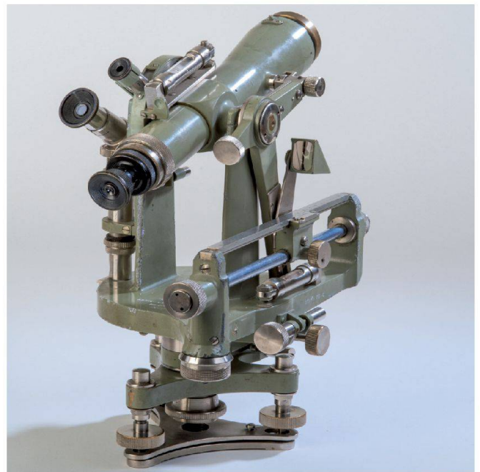
Reduktions-Distanzmesser nach Sanguet für vertikale Latte. Abgeliefert am 22. Januar 1929.
