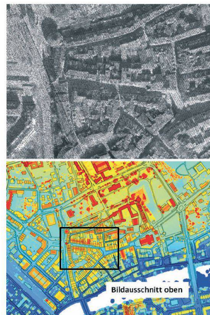
Abb. 1: Aus den LIDAR-Punkten für die Altstadt Solothurn (obere Abbildung) wird ein DOM erstellt (unten), wobei blau niedere Höhen und rot maximale Höhen darstellt.
