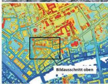
Abb. 1: Aus den LIDAR-Punkten für die Altstadt Solothurn (obere Abbildung) wird ein DOM erstellt (unten), wobei blau niedere Höhen und rot maximale Höhen darstellt.
